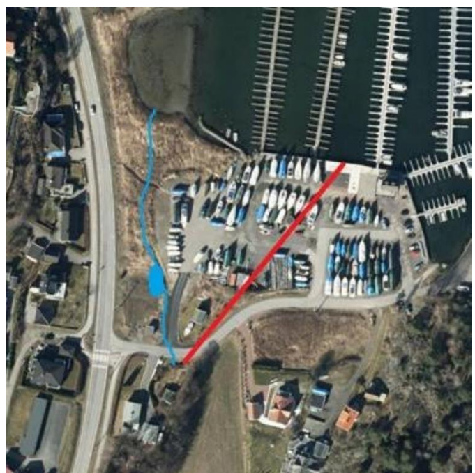
Bekkelukking (rød linje) og ny åpen bekkeutløp i utløpet av Aråsbekken.
