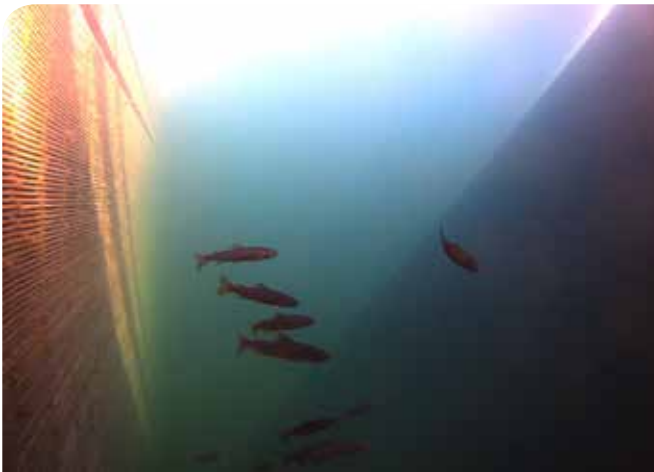
Videostill fra overvåkingen ved beta-rist. Ungfisk på vandring nedstrøms følger risten til luke og avleder. (Foto: Voss Energi, Mohntech, NORCE LFI).
