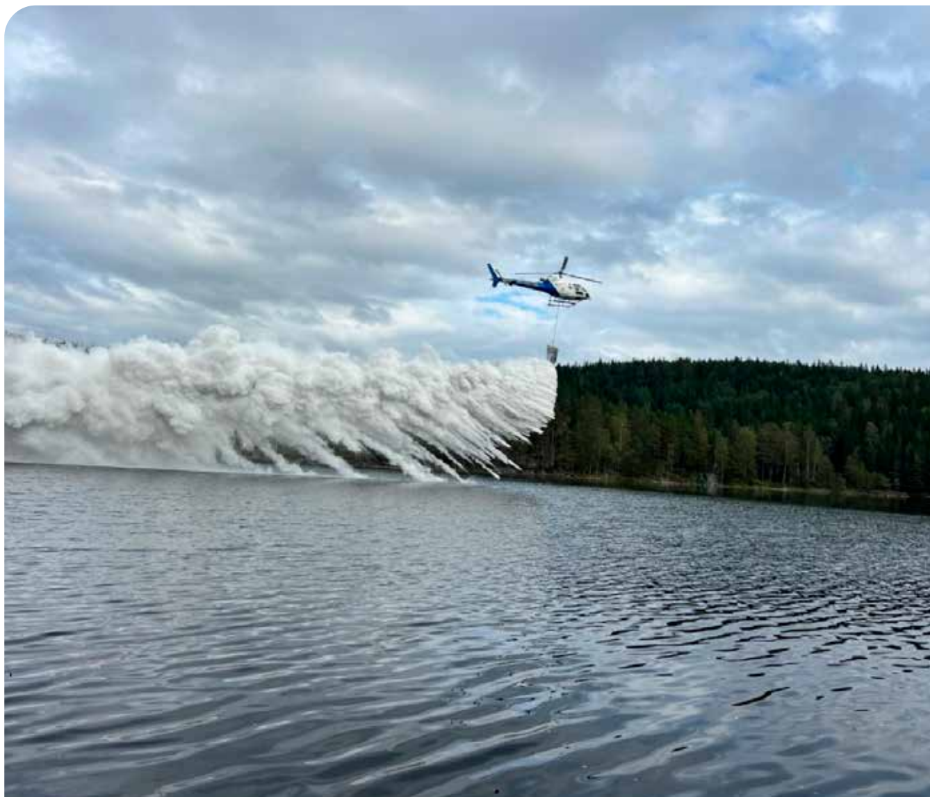
Spredning av kalk med helikopter i Mosjøen, Østmarka nasjonalpark. Foto: Ståle Ellingsen, Franzefoss Minerals AS.
