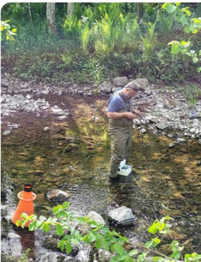
Jon Magerøy måler redokspotensialet i elvegrusen. Dette er et mål på habitatkvalitet for ungmuslinger, og forteller oss om oksygeninnholdet i grusen. Foto: Knut Andreas Eikland, NINA.
