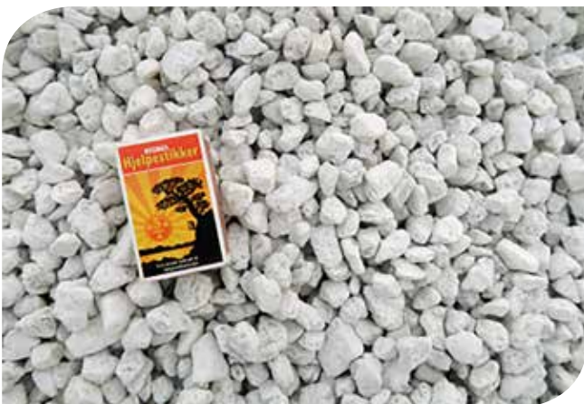
Det ble benyttet en blanding av to fraksjoner naturgrus og en fraksjon kalkstein (bildet). Foto: Helge B. Pedersen.
