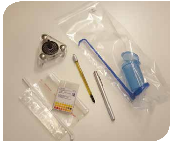
Figur 3. Prøvetakingsutstyr med NINAs egen filterholder for innsamling av prøver for miljø-DNA. Foto: Frode Fossøy.
