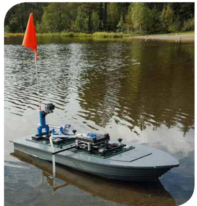
Figur 4. Båt for innsamling av miljø-DNA, «MS EDNA», som er spesiallaget for å ta vannprøver fra innsjøer. Båten har en lengde på ca. 120 cm. Foto: Frode Fossøy.
