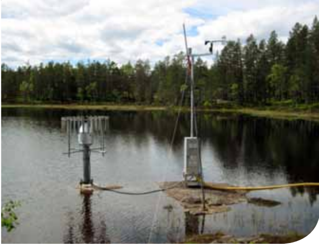
Bilde 2. Solcelledrevet bøye med sensorer for temperatur og oksygenmetning (øverst) og værstasjon med utstyr for måling av nedbør, temperatur, luftfuktighet, solstråling og vind (nederst).
