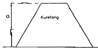
Figur 4A Snitt i vertikalkanen som viser hvordan høyden på kulefanget måles.
