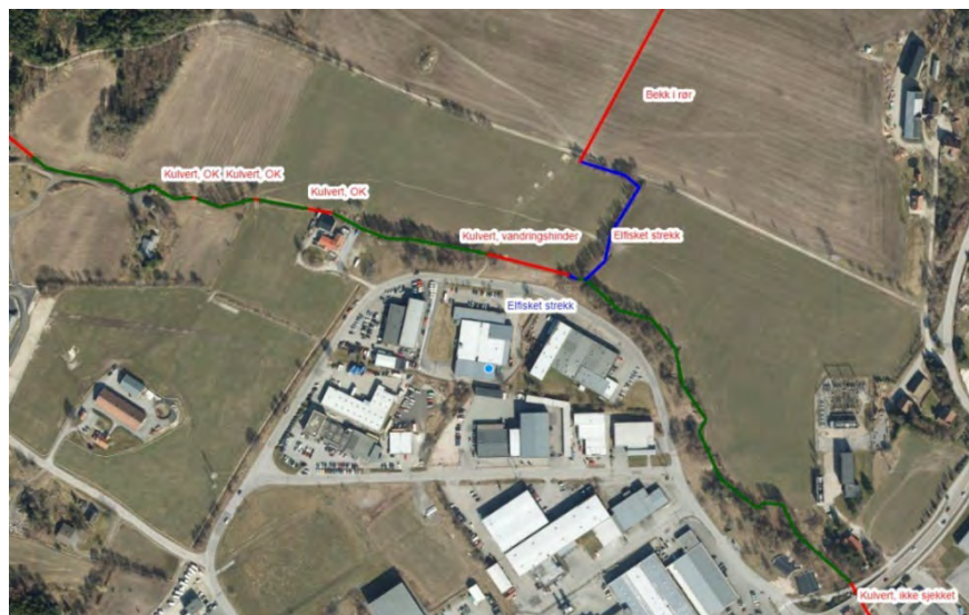
Figur 73 Undersøkte strekk 2020 øverst. Røde kulverter skulle vært oransje, unntatt vandringshinderet.
